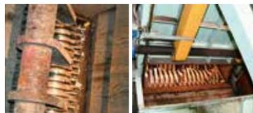
ベルトコンベヤーに乗って破砕機に運ばれていきます。ここに誤って小型充電式電池が混入していると、火災事故へとつながってしまいます。
