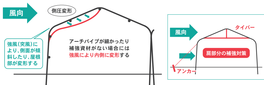
図-2 風上側の屋根部分に変形するパターン
