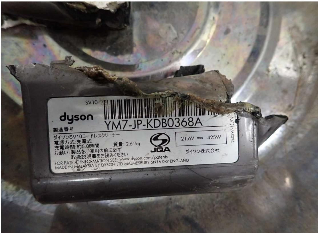
R4.11.30 (水) 10時34分頃出火 粗破砕機にて発見された出火原因 (R4年度8件目)
